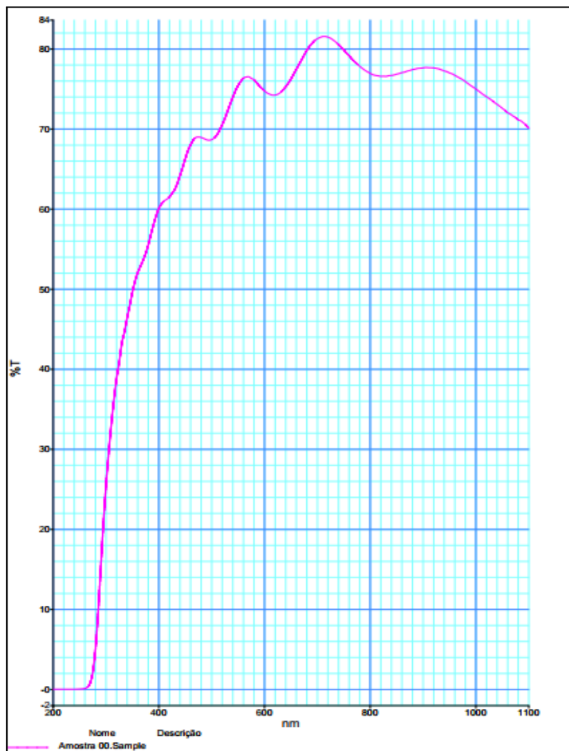
Figura 31: Resultado da transmitância do FTO no UV/VIS.
