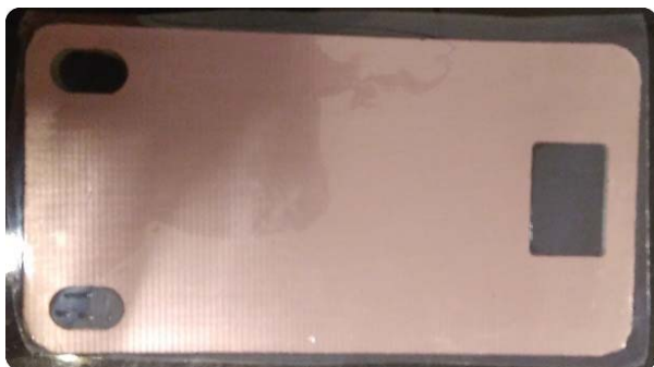
Figure 8: Dryfilm faceado na placa de cobre.
