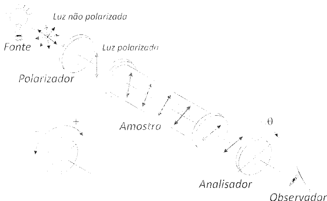
Figura 1.3 – Rotação do plano de polarização da luz por uma substância opticamente ativa. A direção de rotação é uma característica da amostra, sendo a rotação para a direita do observador considerada positiva (Dextrogiro) e para esquerda negativa (Levogiro) [12].
