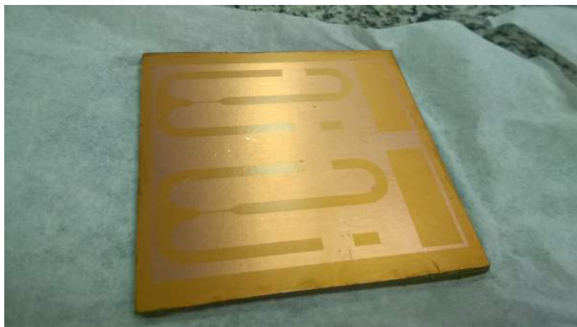
Figura 22 – Foto do substrato após gravação e revelação. As áreas escuras possuem a proteção do resiste, enquanto as áreas claras expõem a camada de cobre diretamente.
