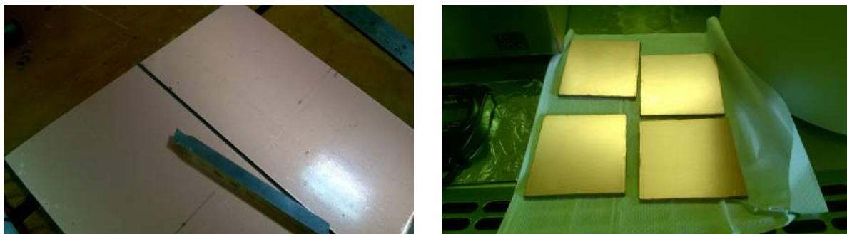
Figura 18 – À esquerda: substrato sendo cortado com ferramenta de corte; à direita: pedaços de substrato limpos para deposição do resiste.
