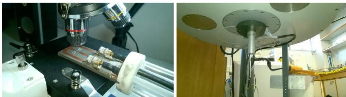
Figura 34 – À esquerda, capilar sendo posicionado sobre o microslot com auxílio do microscópio ótico; À direita: Sonda instalada no espectômetro
