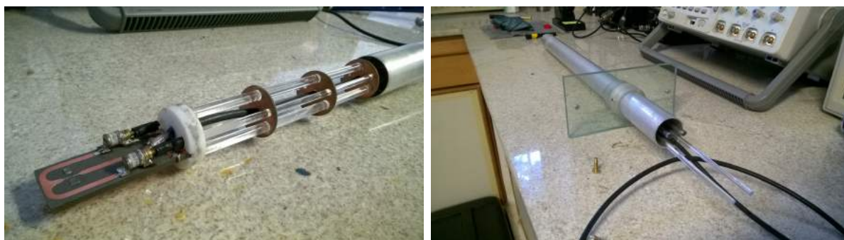
Figura 32 – Fotografias da estrutura da sonda montada. À esquerda, placa com o circuito ressonador encaixada no tarugo de teflon e hastes de suporte presas às guias. À direita, visão do suporte para encaixe no espectômetro.
