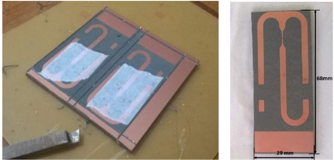
Figura 24 – À esquerda: Fotografia do substrato após corrosão, preparado para o corte da placa de circuito. A fita branca foi colocada para proteger a área do microslot . À Direita: Fotografia da placa de circuito contendo o microslot .
