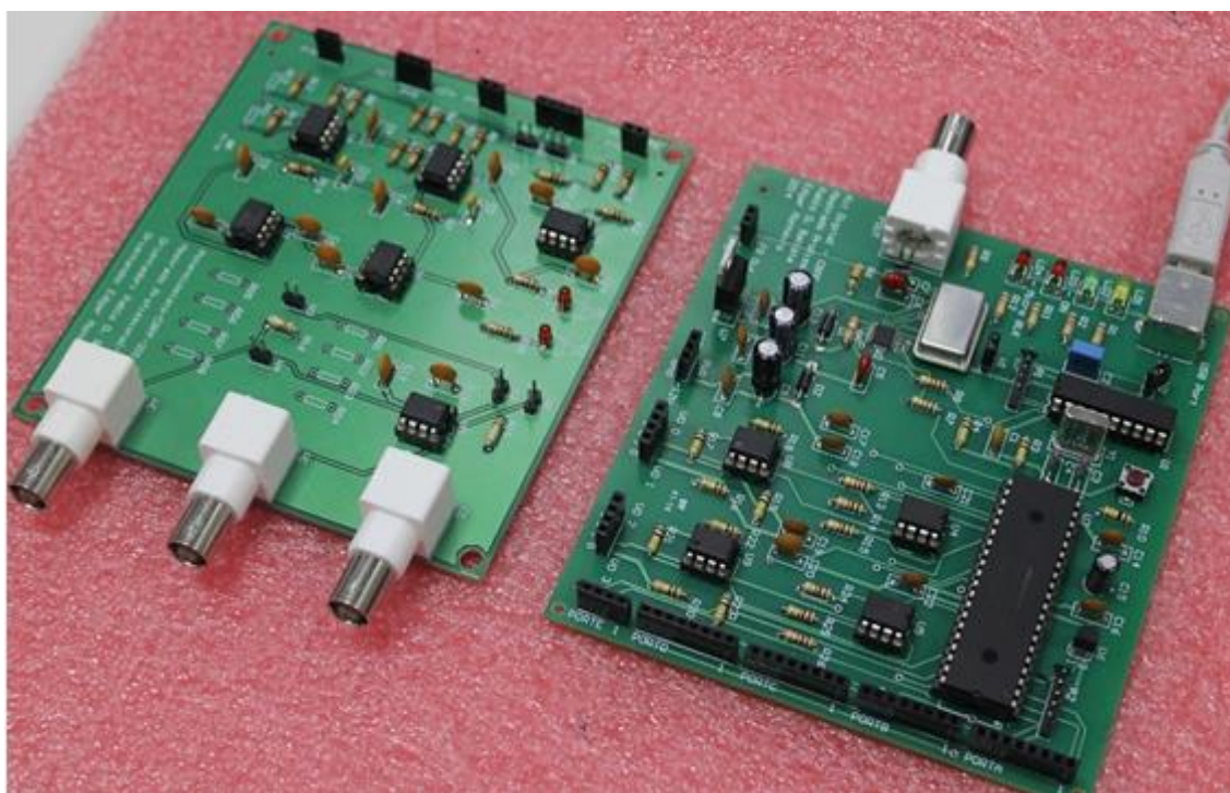
Figura 4.2: Protótipo para a deposição de ZnO utilizando a técnica de eletrodeposição.
