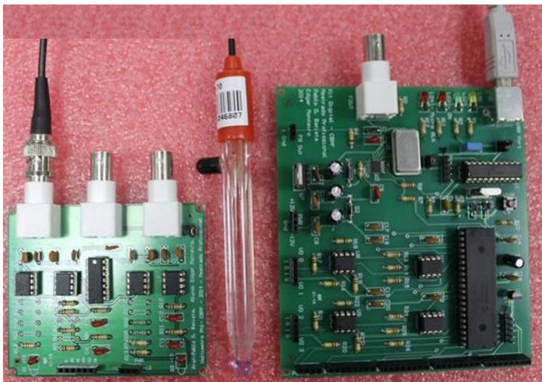
Figura 4.1: Protótipo para a caracterização elétrica do EGFET como sensor de pH.
